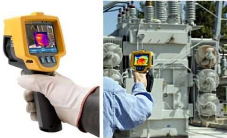
Figura 8. Inspección por termografía Infrarroja [9]
