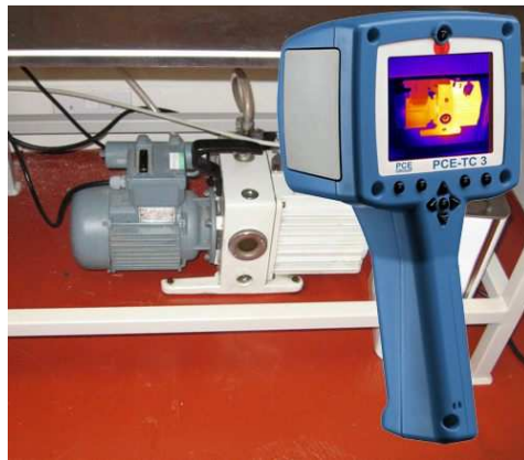
Figura 6. Termografía infrarroja en acción [12]
