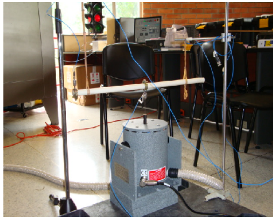
Figura 22. Ensayo en Proceso del Shaker (MODAL 50 A EXCITER.)
