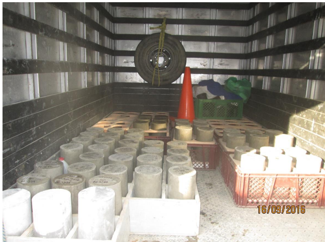
Figura 20. ENVIO DE MUESTRAS DE CONCRETO
