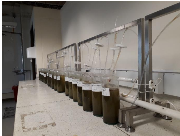
Imagen 12 Montaje de los reactores
