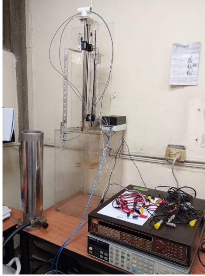
Figura 30. Montaje experimental usado para medir las corrientes en función del voltaje para diferentes dispositivos a diferentes temperaturas.
