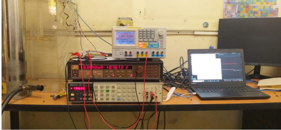
Figura 33. Montaje experimental del banco de pruebas con la fuente regulada de voltaje ODP3032.
