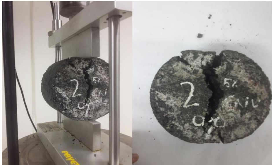
Figura 7 Briqueta fallada por la prensa Marshall.
