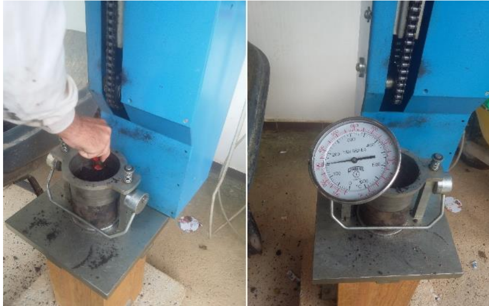
Figura 5 Preparación de la mezcla pasa su compactación.
