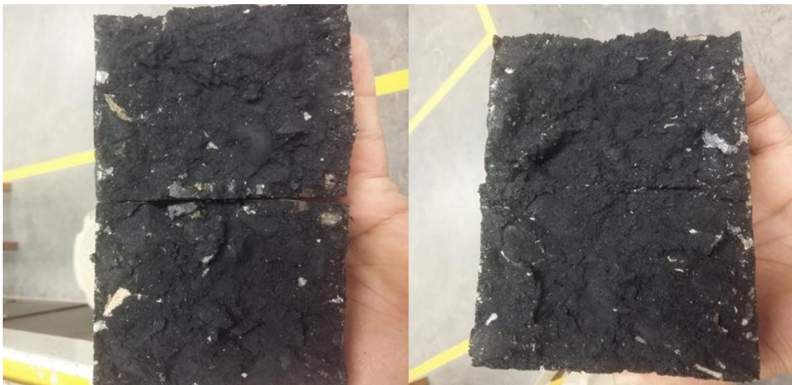
Grafica 30 Daño por humedad luego de la fractura (Mezcla Modificada)
