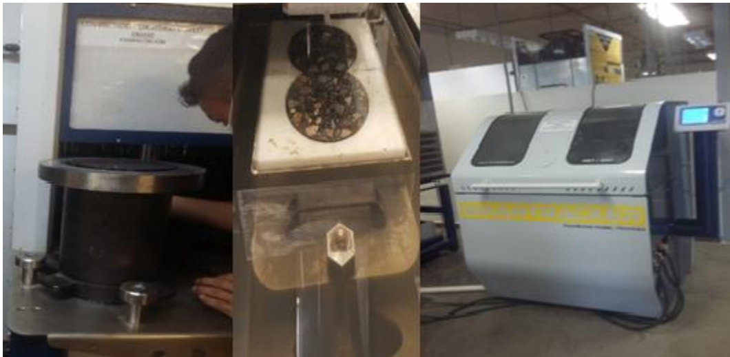
Figura 9 Muestra y dispositivo de seguimiento de la rueda de Hamburgo.
