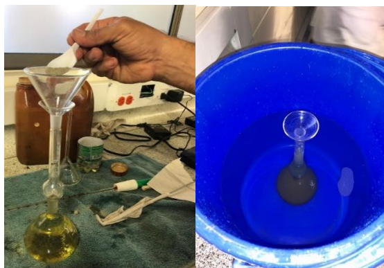
Figura 23. Densidad del cemento hidráulico, frasco de Le Chatelier. Fuente: Propia. Universidad Pontificia Bolivariana.
