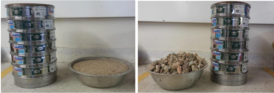
Figura 24. Proceso de tamizado de los agregados fino y grueso. Fuente: Propia. Universidad Pontificia Bolivariana.
