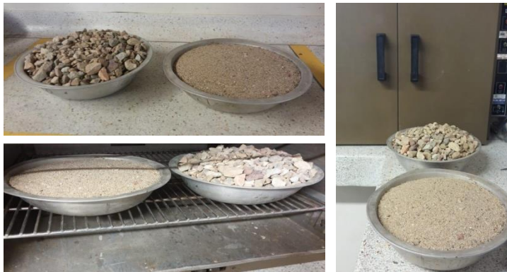
Figura25. Contenido de humedad de los agregados. Fuente: Propia. Universidad Pontificia Bolivariana.
