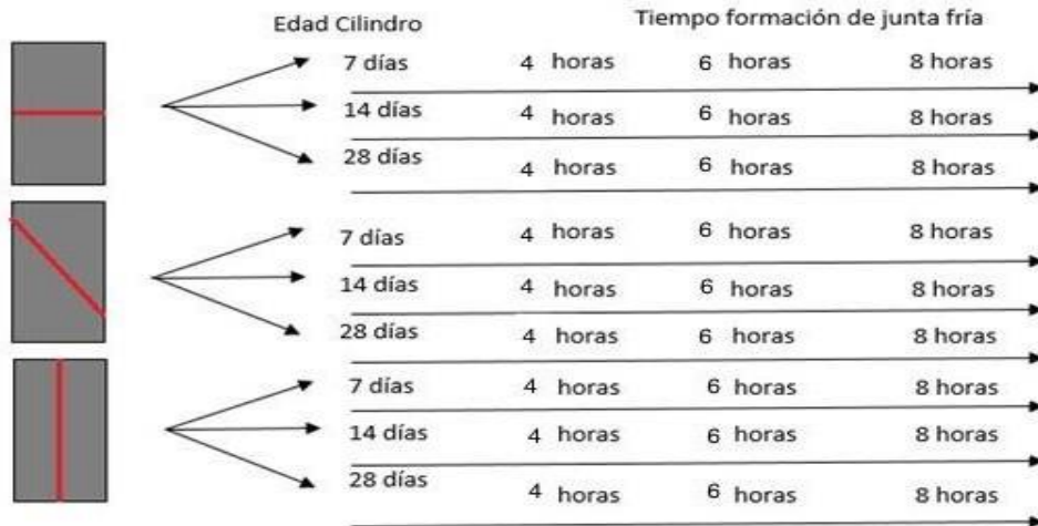
Figura 9. Experimentos de cilindros de concreto con junta fría lisa. Fuente: Adaptado de [2].
