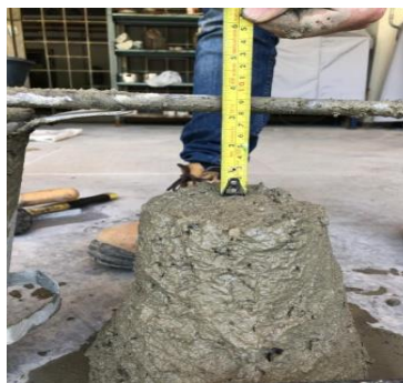
Figura B 1. Asentamiento del concreto.
