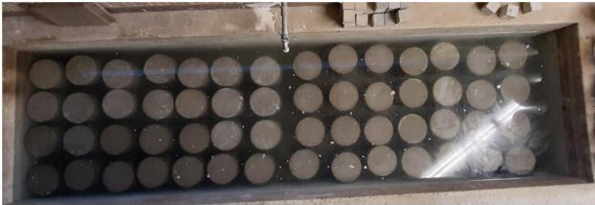
Figura 19. Cámara de curado. Fuente: Propia. Universidad pontificia Bolivariana.
