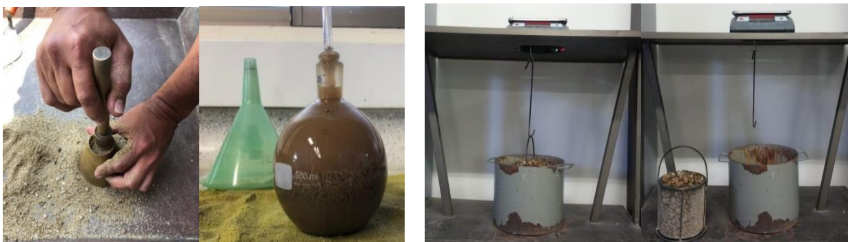
Figura 27. Peso específico y absorción del agregado fino y grueso. Fuente: Propia. Universidad Pontificia Bolivarian0a.
