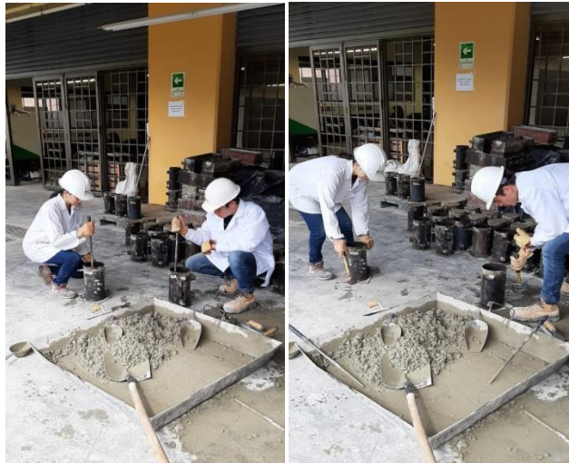
Figura 15. Compactación de cilindros. Fuente: Propia. Universidad pontificia Bolivariana.
