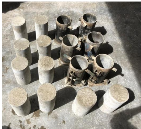
Figura 18. Desencofrado de probetas cilíndricas metálicas. Fuente: Propia. Universidad pontificia Bolivariana.
