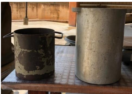
Figura 26. Masa unitaria compacta y suelta de los agregados. Fuente: Propia. Universidad Pontificia Bolivariana.
