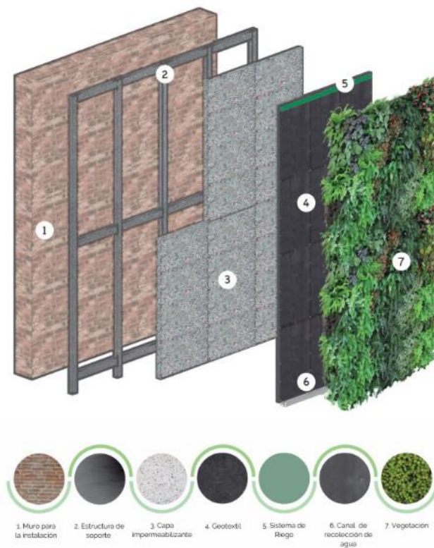
Figura 7. Estructura de un muro verde. fuente: Inarquia.
