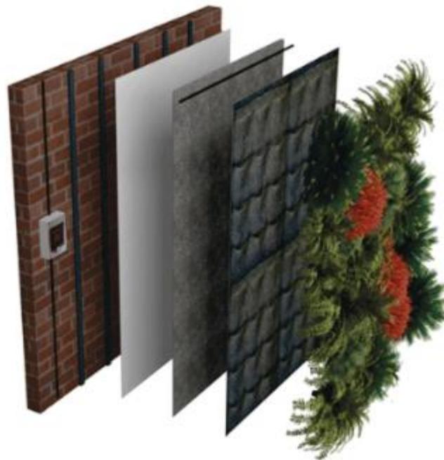
Figura 5. Ejemplo de un sistema hidropónico. Fuente Paisajismo Urbano.
