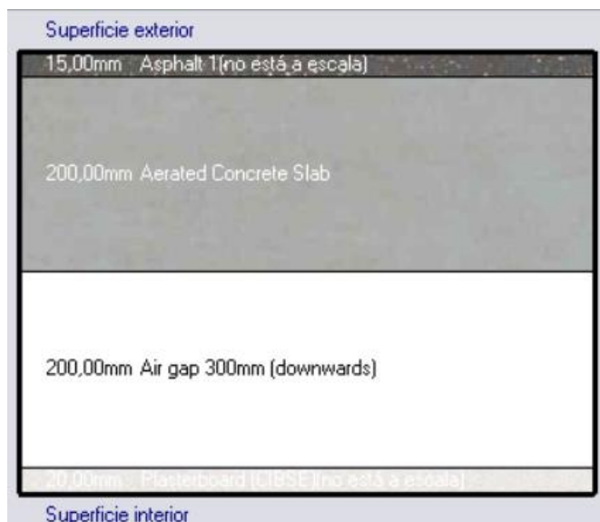
Figura 16. Cubiertas del edificio. Fuente: Propia.
