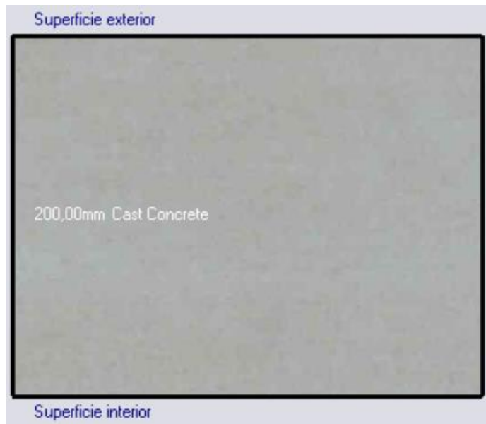
Figura 15. Muros enterrados del edificio. Fuente: Propia.
