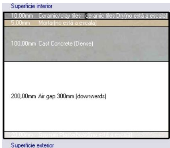
Figura 17. Losas de entre piso del edificio. Fuente: Propia
