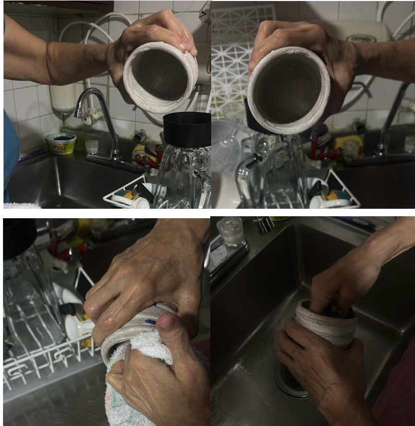
Figura 5. Prueba de limpieza. Secuencia antes y después del paño húmedo mostrando limpieza eficaz.
