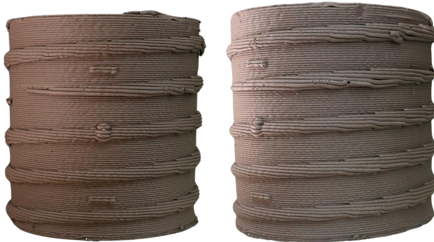
Figura 4. Fotografía del prototipo cerámico impreso en 3D hasta la mitad. Vista lateral con textura helicoidal.
