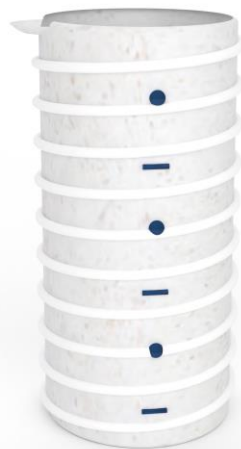
Figura 3. Render del modelo 3D con forma cilíndrica y relieve helicoidal marcado. Vista isométrica.
