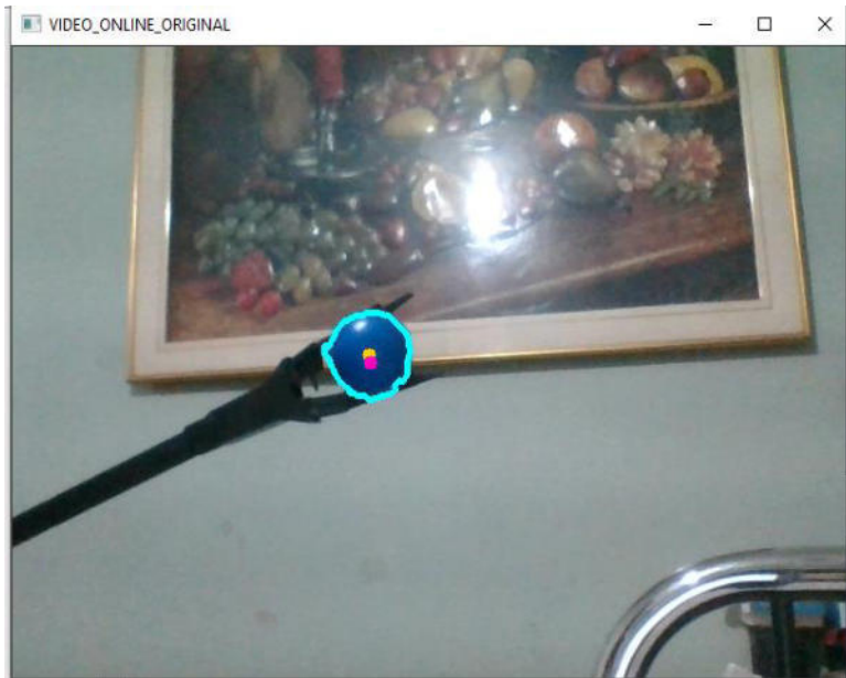
Figura 31. Calculo y dibujo de la predicción del filtro de Kalman plano (x,y).
