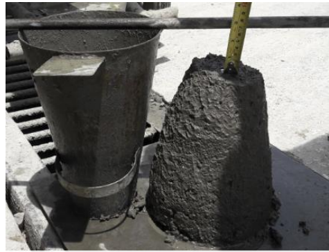
Imagen 46 Manejabilidad Prueba C303430 Fuente: PROPIA
