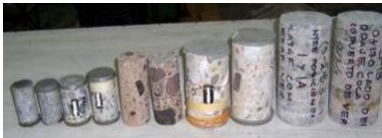
Imagen 16. Extracción de núcleos Fuente: PROPIA
