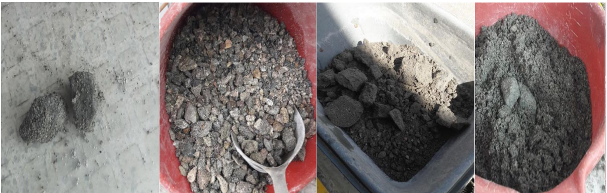
Imagen No 41 Estado de los agregados Reciclados Fuente: PROPIA
