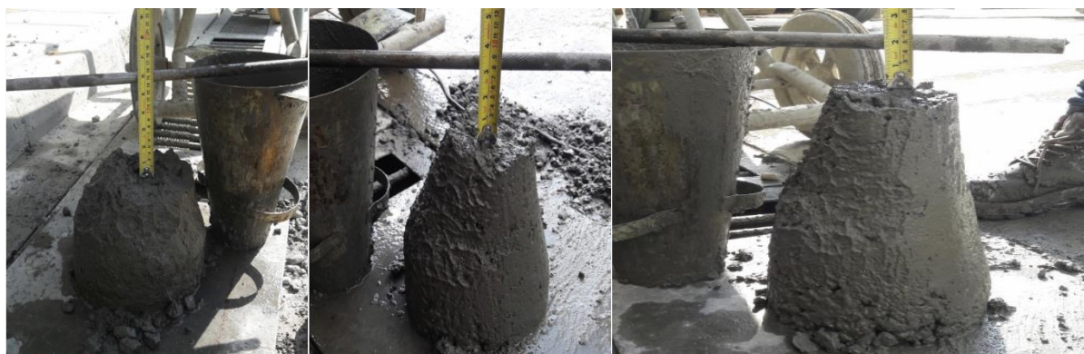
Imagen No 44 Manejabilidad Prueba C303410 Fuente: PROPIA
