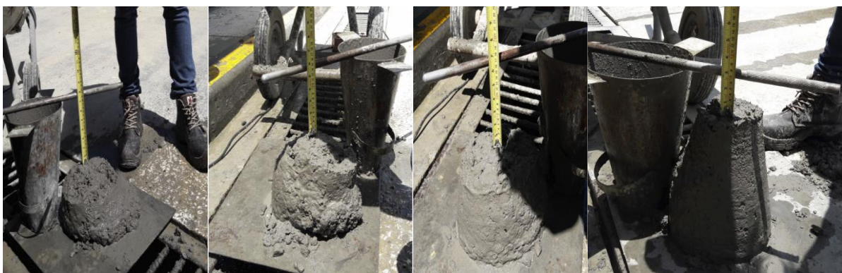
Imagen No 43 Manejabilidad Prueba Patrón C3034NO Fuente: PROPIA
