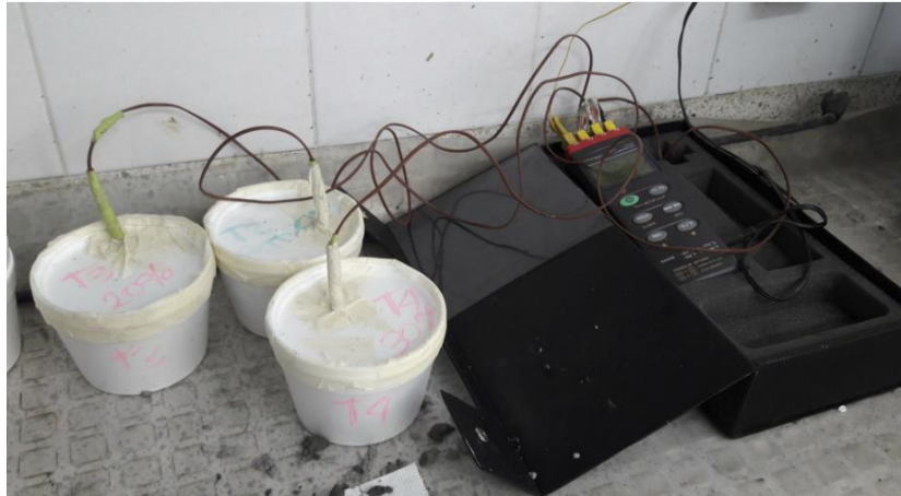
Imagen No 48 Termocuplas Fuente: PROPIA
