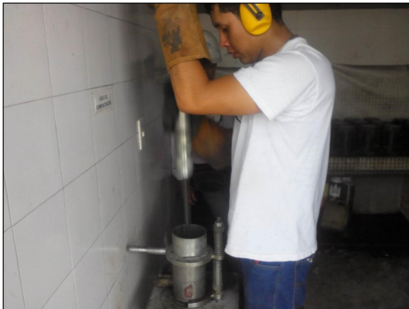
Figura 21. 75 golpes con el martillo de compactación equipo Marshall
