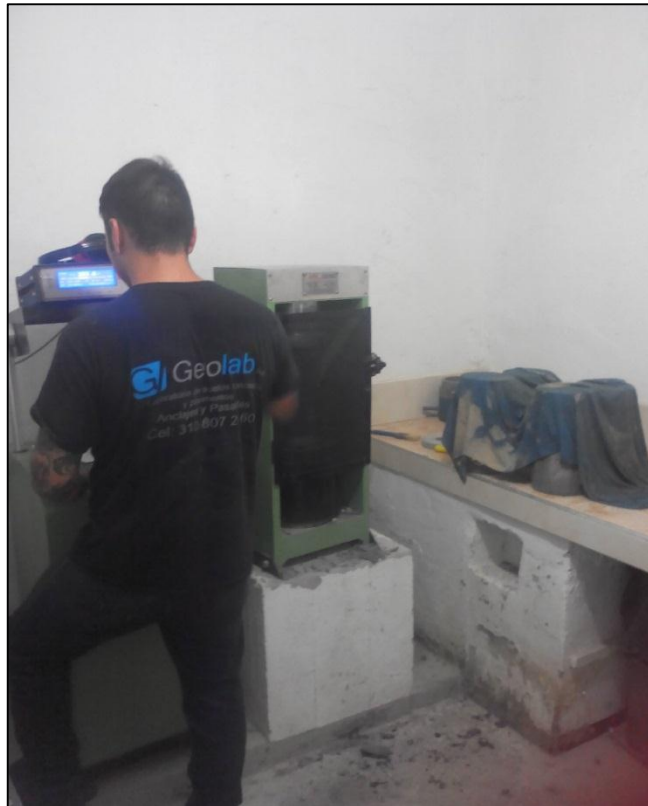
Figura 14. Prensa para ensayos de compresión del concreto.
