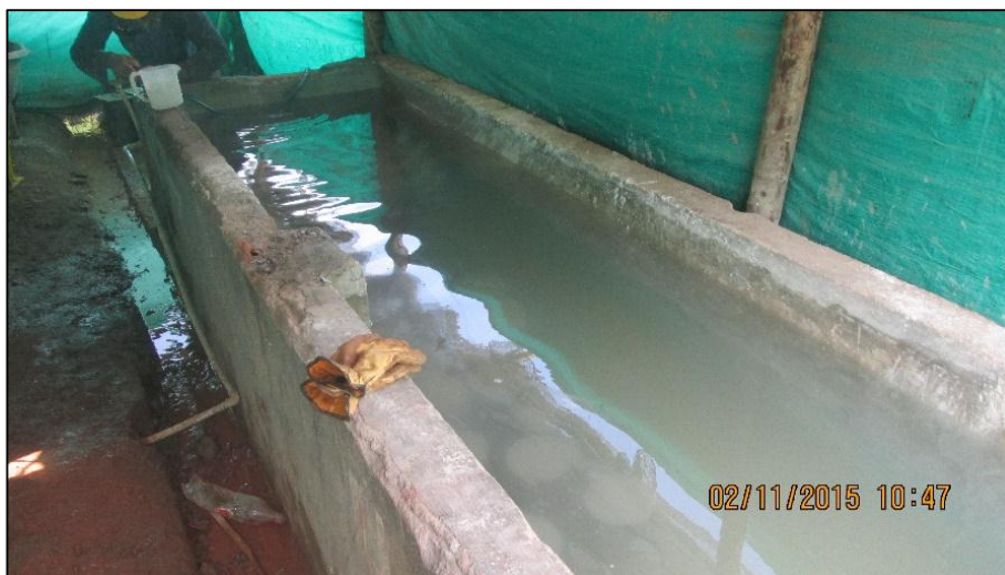
Figura 2. Piscina curado de los especímenes de concreto.
