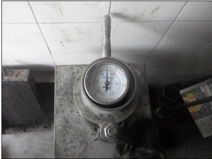
Figura 20. Medición de temperatura de la mezcla
