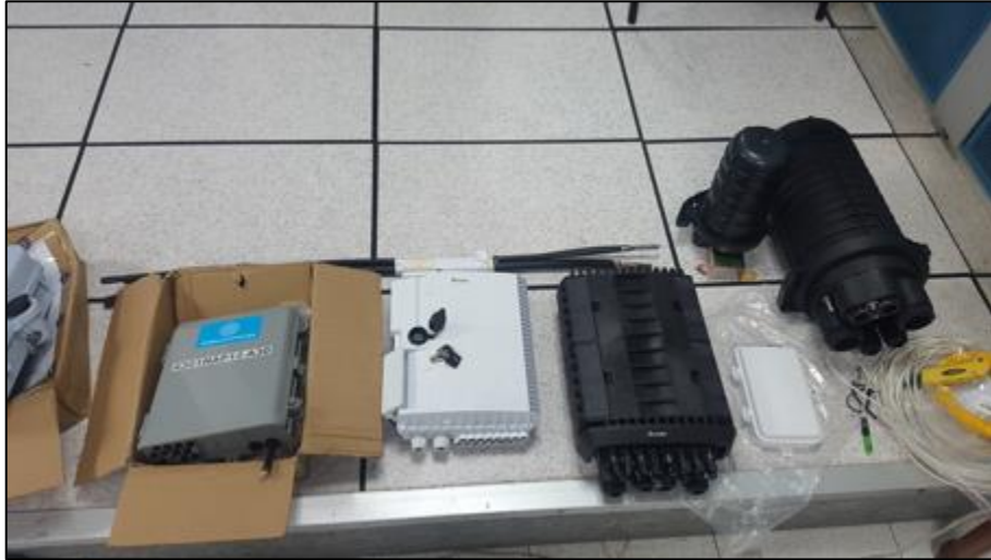
Figura 8 Elementos de infraestructura de la red FTTH (Nap Indoor, Nap outdoor, domo, Fibra) Fuente: Autor
