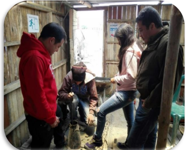
Figura 4: Toma de cilindros de concreto Berlín, Santander.
