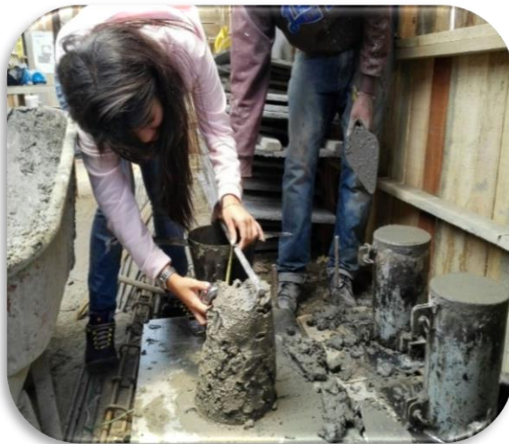
Figura 5: Toma Ensayo Slump – Cono de Abrahams, Berlín, Santander.
