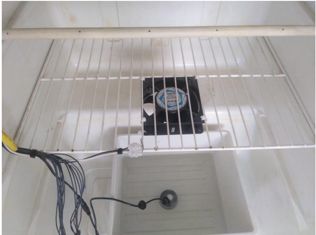
Ilustración 4. Ventilador, humidificador y tubo de salida de gas.
