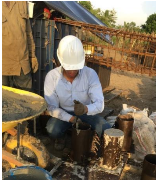
Ilustración 24: Elaboración de cilindros de concreto
