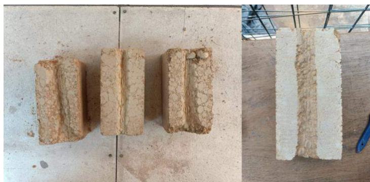
Fig. 75 Ensayo resistencia a la abrasión en BTC de prueba sin pintura, con pintura, con pintura con nanopartículas
