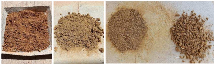
Fig. 63 Tamaño y color de partículas de suelo para BTC.
