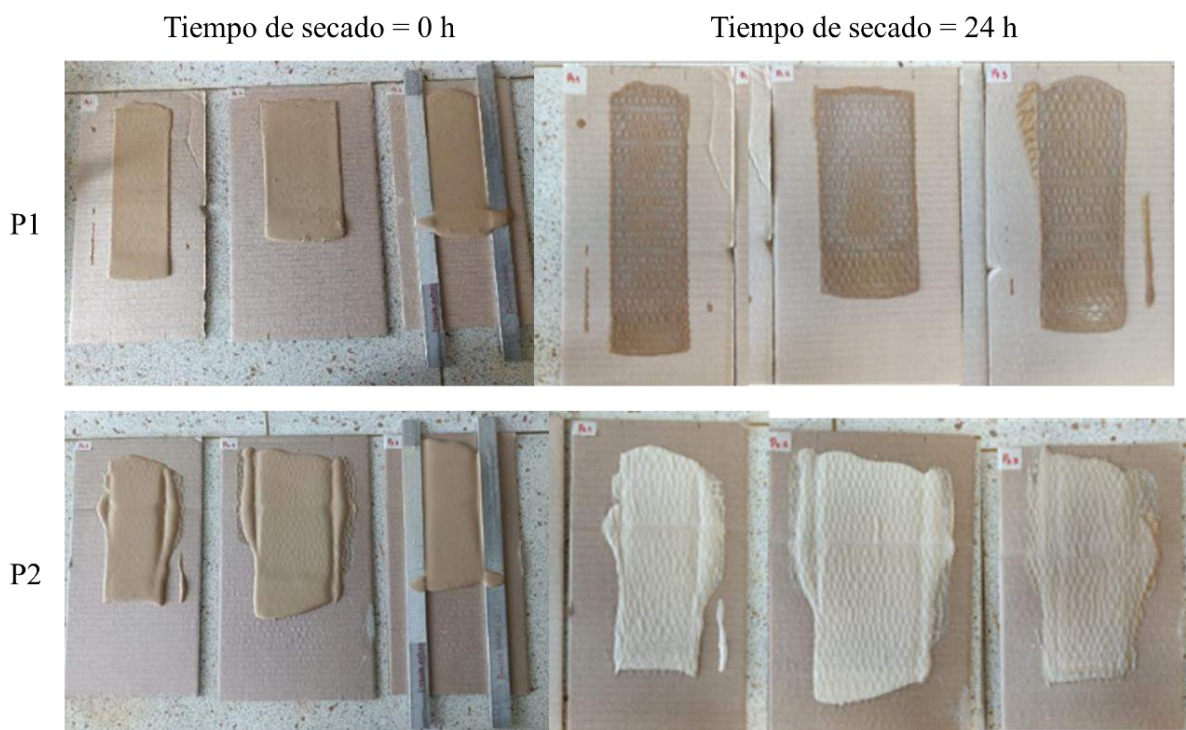
Fig. 48 Resultado ensayo cuarteamiento aplicando un alto espesor pinturas naturales P1 y P2.
