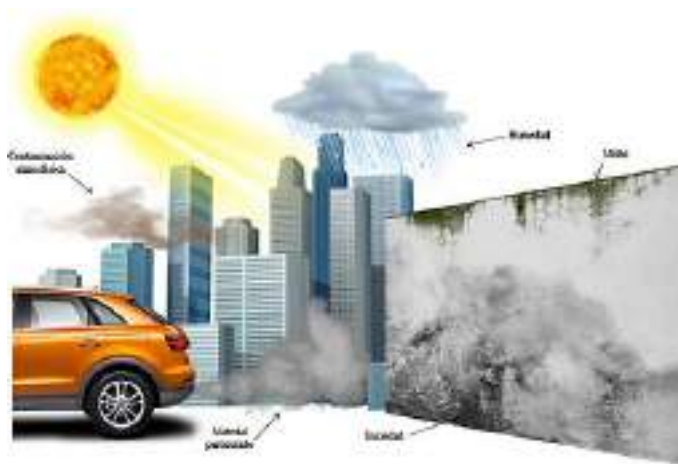
Fig. 16 Agentes deteriorantes de las fachadas de edificaciones [30].
