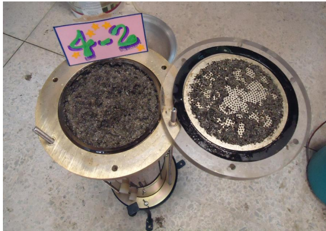
Figura 10. Desmontaje de las Columnas de Suelo
