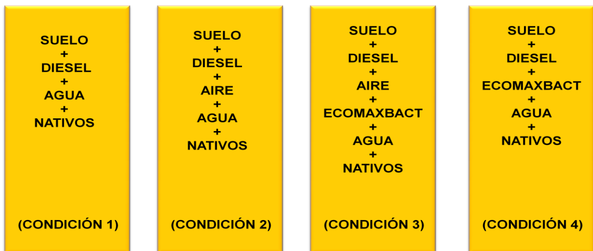
Figura 8. Montaje experimental de las columnas de suelo.
