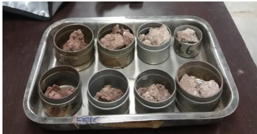
Figura 15. Ensayo de compactación, muestras de humedad.
