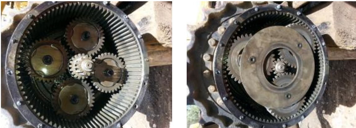
Figura 09 Engranajes planetarios del motor de traslación. (KATO WORKS CO., 2010)
