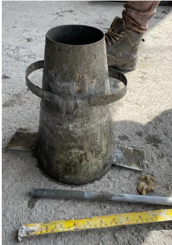
Figura 13. Cono de Abrams para ensayo de Slump.
