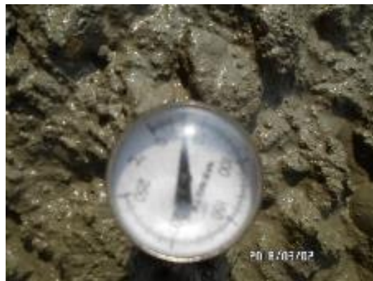
ENSAYO EN CAPO PARA MEDICIÓN DE LA TEMPERATURA EN CONCRETO FRESCO
