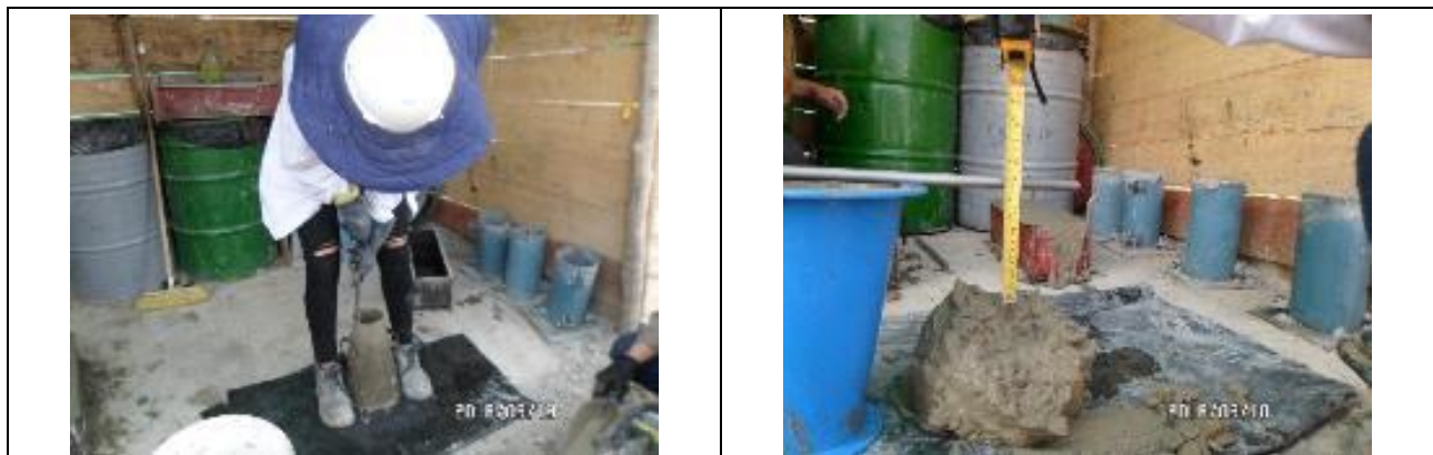
ENSAYO DE CAMPO PARA MEDICIÓN DEL SLUMP FLOW, ASENTAMIENTO DEL CONCRETO FRESCO
