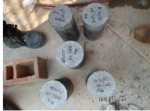
ESPECÍMENES DE CONCRETO PARA ENSAYO DE RESISTENCIA A LA COMPRESIÓN Y FLEXIÓN
