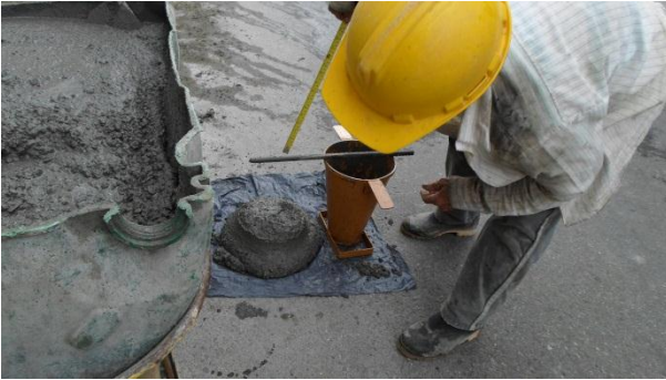
Ilustración 3: Ensayo de asentamiento mediante el cono de Abrams. Fuente: Peralta Ingeniería S.A.S.
