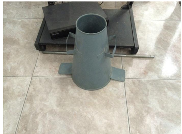
Ilustración 3: Cono de Abrams para ensayo de asentamiento del concreto. Fuente: Peralta Ingeniería S.A.S.
