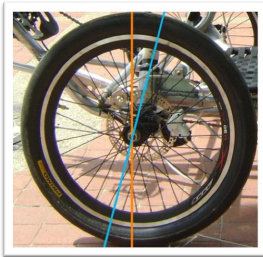
Figura 49. Vista lateral de la rueda izquierda. La línea azul muestra la orientación dada al caster del vehículo en las dos ruedas. Fuente Franklin Patiño.
