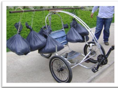
Figura 45. Prueba de carga de la barra antivuelco. A la Izquierda se muestra el vehículo soportando la carga de 200 Kg. A la Derecha se muestra el pesaje de las bolsas de arena empleadas en la prueba. Fuente: Franklin Patiño.
