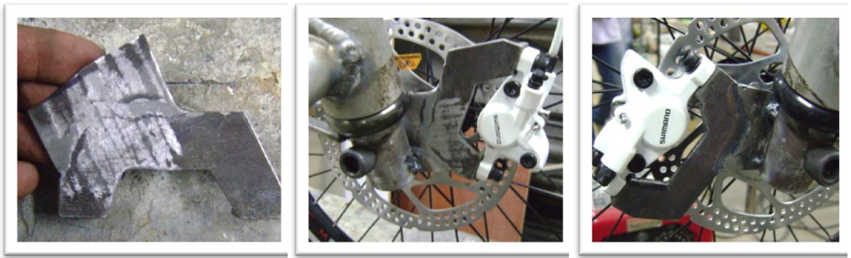
Figura 42 Montaje de las mordazas de freno. Se puede observar las diferentes posiciones de instalación de las mordazas. Fuente: Franklin Patiño.
