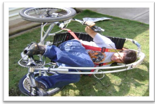
Figura 46 Prueba de Volcadura del vehículo. Se muestran las posibles posiciones que tomaría el vehículo, al momento de una volcadura. Fuente: Franklin Patiño.
