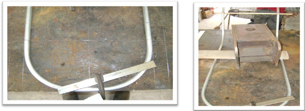
Figura 39. Proceso de construcción de la estructura de la silla. Se pueden apreciar las líneas constructivas sobre la superficie de trabajo para garantizar la correcta forma, además de la sujeción e inmovilización necesaria durante el proceso de soldadura. Fuente: Franklin Patiño.
