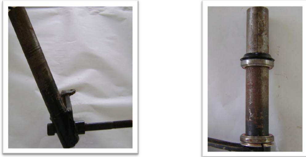
Figura 41. Kingpin ó “caña” de dirección. A la izquierda: se aprecia el ángulo entre el eje del Kingpin y el tornillo que soportará la rueda. A la Derecha se muestra la posición aproximada que tendrán los rodamientos sobre el Kingpin. Fuente. Franklin Patiño.
