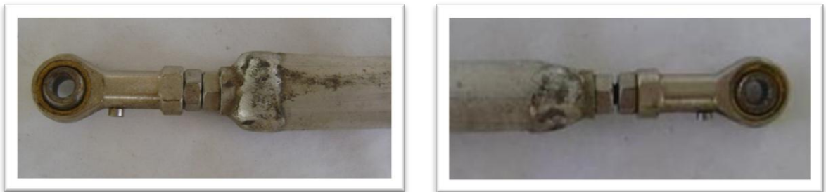
Figura 43. Terminales esféricos de la dirección, estas terminales son roscadas en los extremos de la barra de enlace, en la imagen se observan las tuercas utilizadas para alinear las ruedas y establecer la convergencia (Toe) deseada en el vehículo. Fuente: Franklin Patiño.
