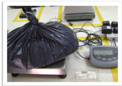
Figura 45. Prueba de carga de la barra antivuelco. A la Izquierda se muestra el vehículo soportando la carga de 200 Kg. A la Derecha se muestra el pesaje de las bolsas de arena empleadas en la prueba. Fuente: Franklin Patiño.
