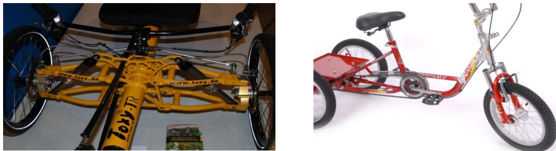
Figura 19. Suspensión delantera. A la izquierda, compleja suspensión delantera para una configuración Tadpole, Tomada de: http://www.recumbent-gallery.eu/wp-content/uploads/toxy-pirol-trike-pj049257.jpg . A la derecha, suspensión delantera típica para una configuración Delta. Tomada de: http://www.bikedock.com/custom/08mission/BMX trike16.jpg
