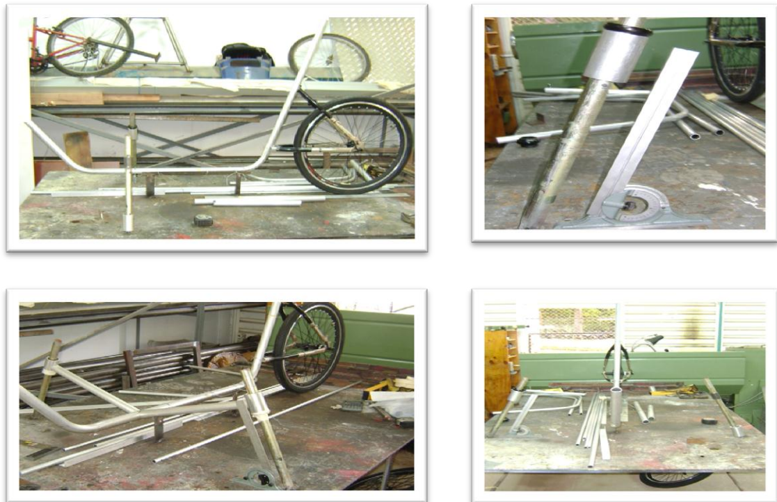
Figura 38. Construcción del Chasis. Superior Izquierda: se aprecian los soportes soldados a la mesa de trabajo en una vista lateral. Superior Derecha: medición del ángulo del Kingpin. Inferior Izquierda: posición de los brazos de soporte para la dirección. Inferior Derecha: vista frontal, se observan los ángulos de Kingpin y la perpendicularidad del chasis respecto a la superficie de trabajo. Fuente: Franklin Patiño.
