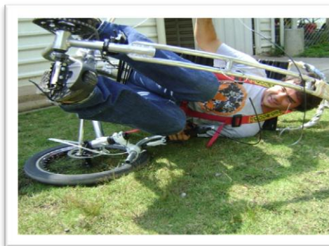
Figura 46 Prueba de Volcadura del vehículo. Se muestran las posibles posiciones que tomaría el vehículo, al momento de una volcadura. Fuente: Franklin Patiño.
