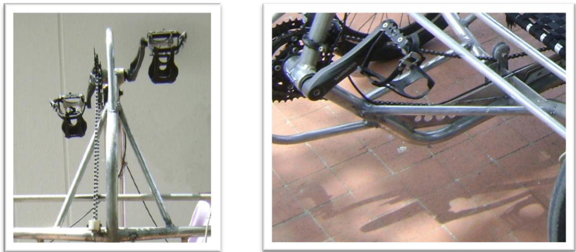
Figura 51. Vistas de los refuerzos para mantener la posición de los pedales. Fuente: Franklin Patiño.
