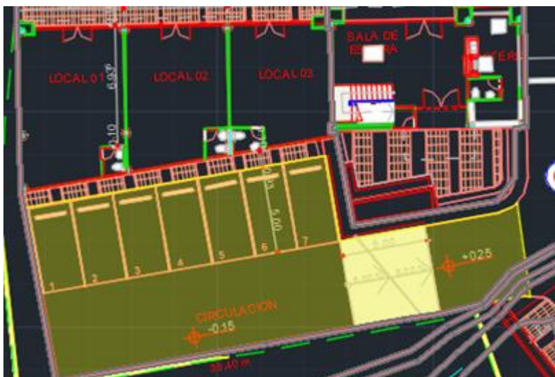
Figura 39, Vía presupuestada para construcción en concreto
