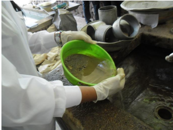
Lavado del material de agregado fino
