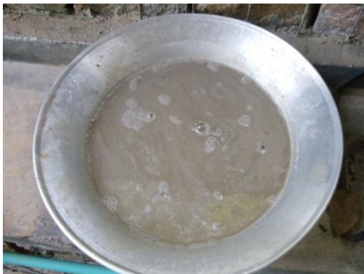
Figura 2. Lavado del material de Agregado Fino
