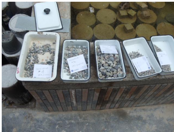
Figura 18. Procedimiento del ensayo de solidez de los agregados.
