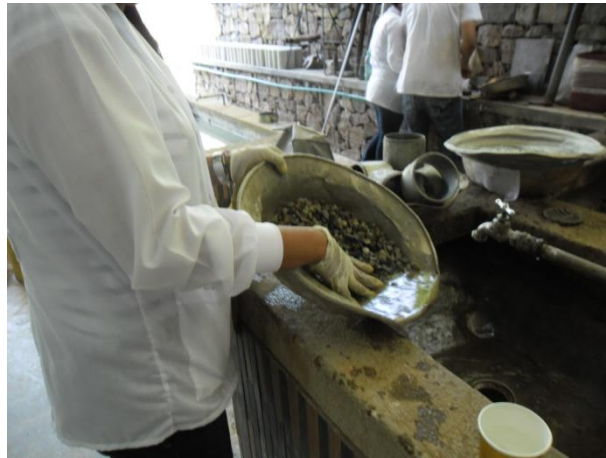
Lavado de material agregado grueso
