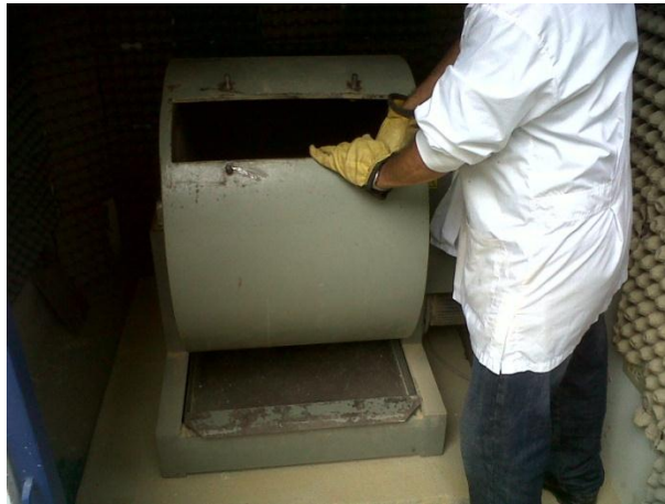
Figura 14. Equipo del ensayo de la resistencia al desgaste de la Maquina de los Ángeles
