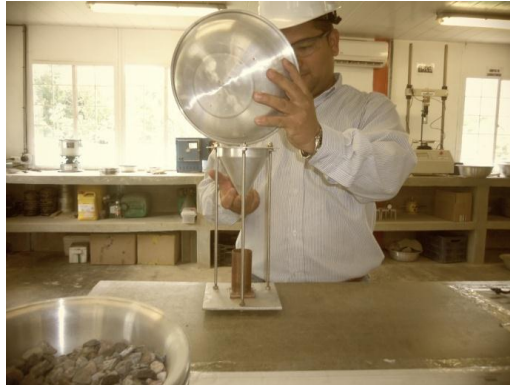
Figura 19. Procedimiento del ensayo de angularidad de la arena
