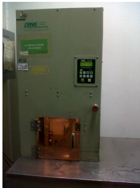
Figura 31. Equipo Compactador Giratorio Superpave
