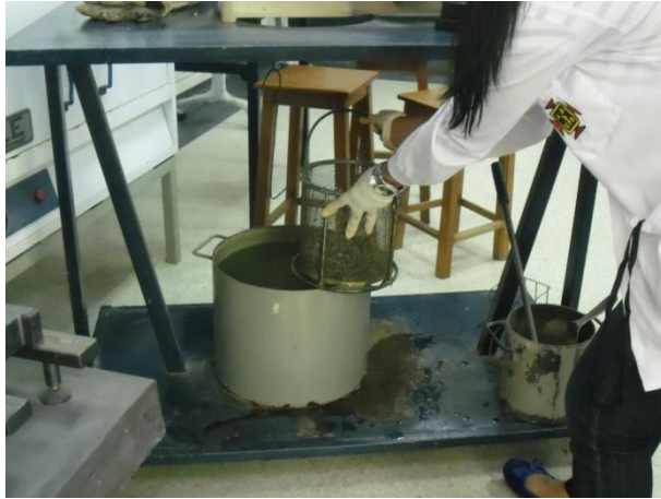
Introduciendo el material de agregado grueso, para después ser pesado.
