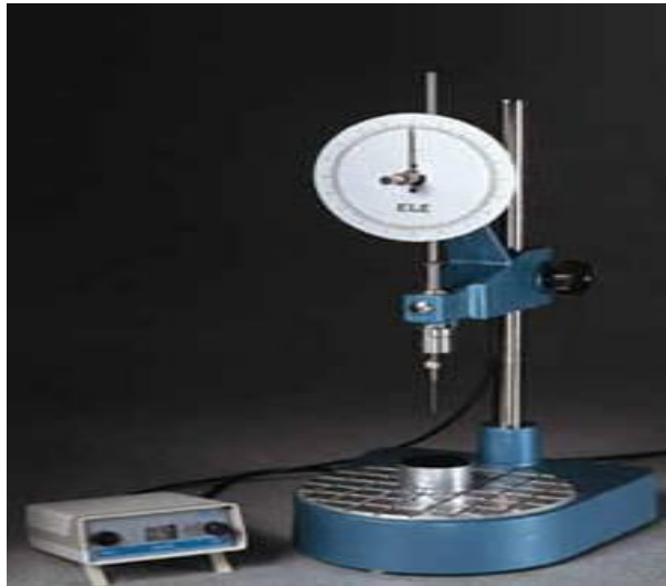
Figura 22. Equipo del ensayo de penetración
