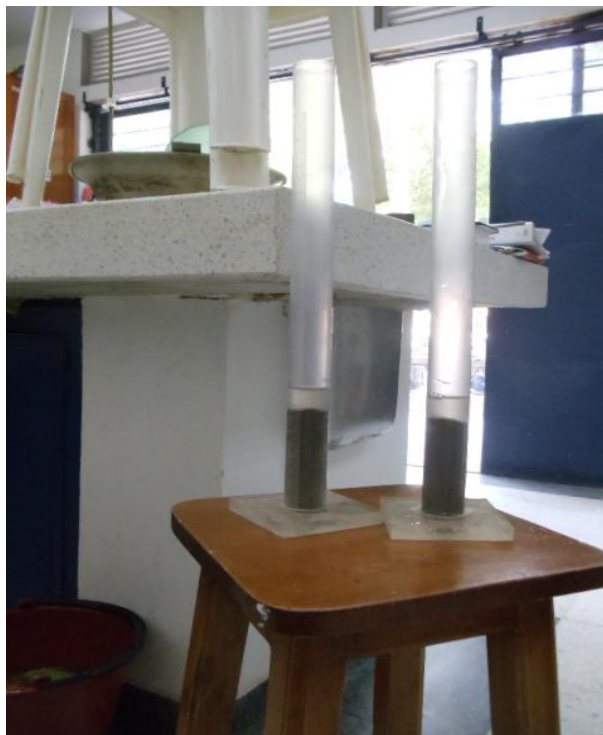
Figura 17. Procedimiento del ensayo equivalente de arena
