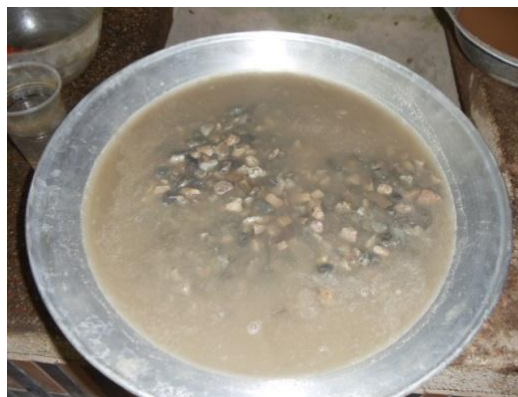
Figura 1. Lavado del material de Agregado Grueso
