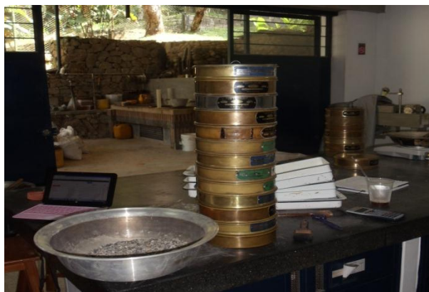
Figura 4. Equipo para ensayo del análisis granulométrico
