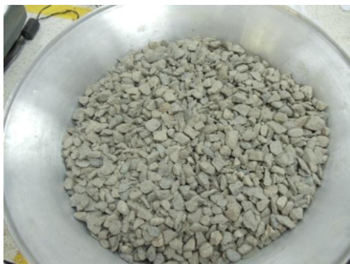
Figura 3. Agregado Grueso después de haberlo sacado del horno
