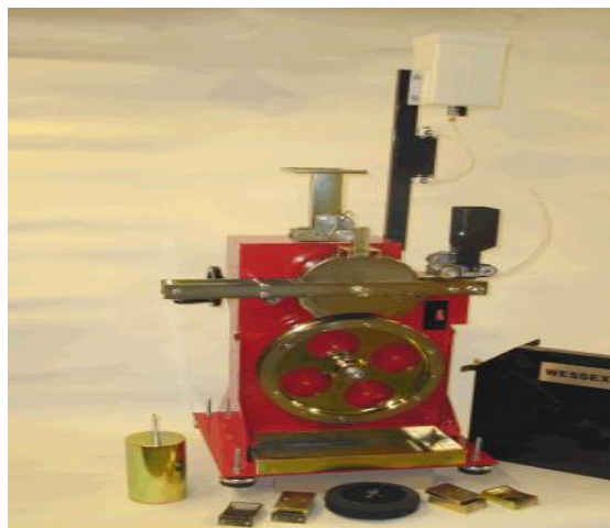
Figura 21. Equipo del ensayo de CPA
