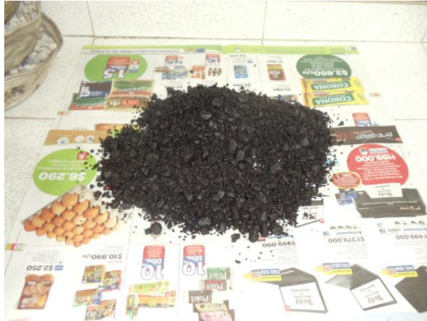
Figura 26. Procedimiento del ensayo Gmm Rice
