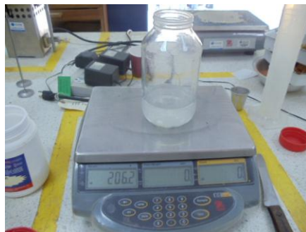
Figura 13. Procedimiento del ensayo de contenido de materia orgánica
