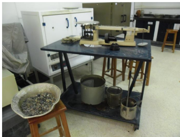
Equipo del peso específico de los agregados gruesos.
