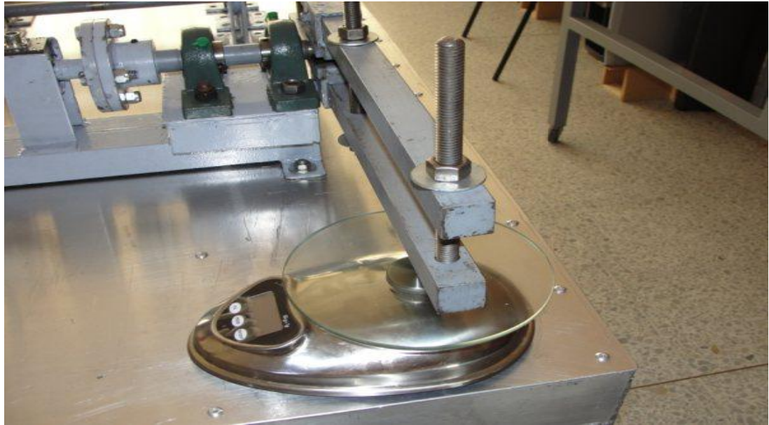
Figura 49. Utilización de la balanza para calcular el torque de frenado
