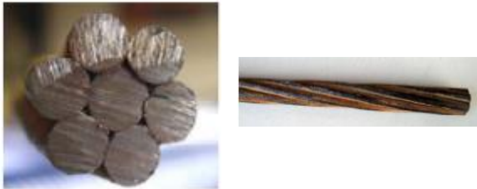
Figura 26. Cables de acero
