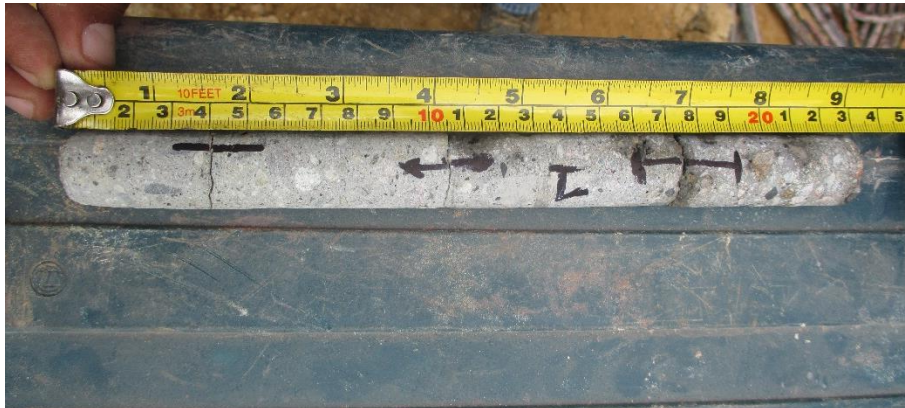
Figura 68. Núcleo extraído de una pantalla anclada
