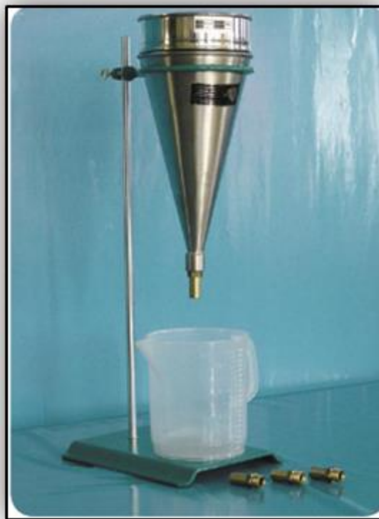
Figura 85. Cono de Marsh para determinar la fluidez
