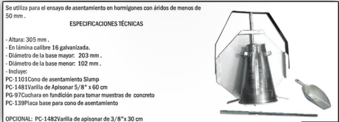
Figura 90. Especificaciones del conjunto para determinar el asentamiento del concreto
