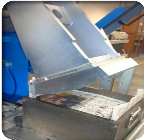
Adición del asfalto, mezclado de materiales, llenado del molde para paneles y disposición del molde junto con el material en el equipo roller compacter
