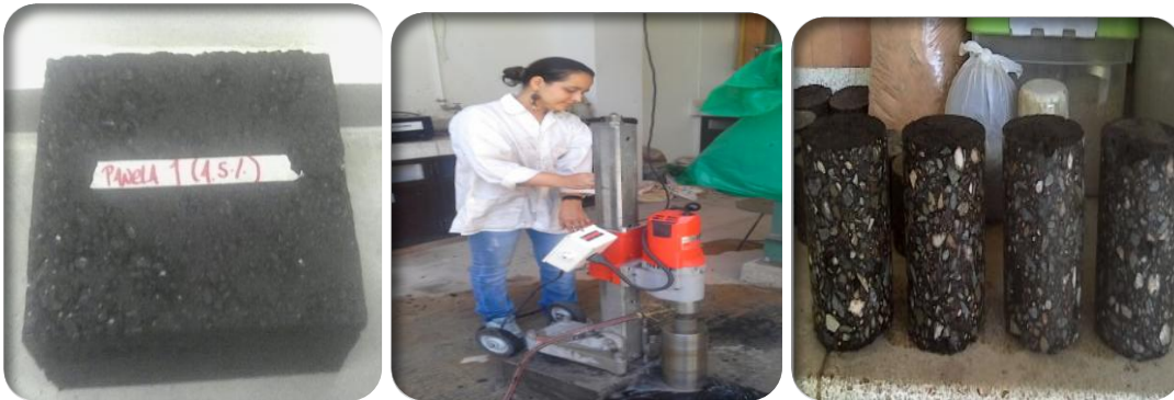
Panela terminada y extracción de núcleos
