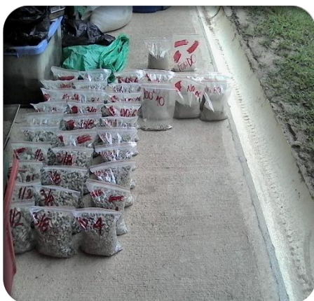
Tamizado y separación de las cantidades a utilizar para la elaboración de paneles
