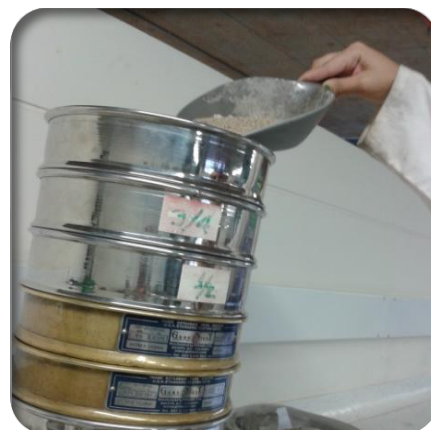
Tamizado y separación de las cantidades a utilizar para la elaboración de paneles
