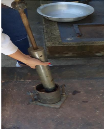
Foto 8. ejecución ensayo de compactación
