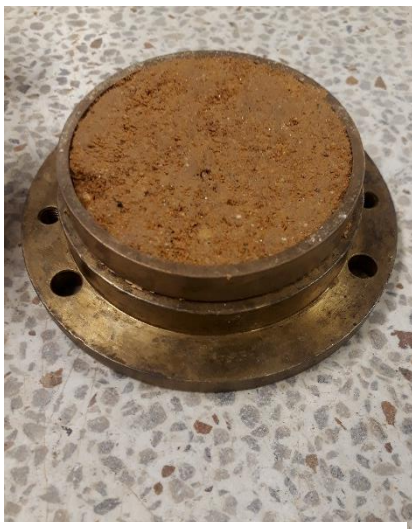
Foto 22. Muestra en molde de consolidación
