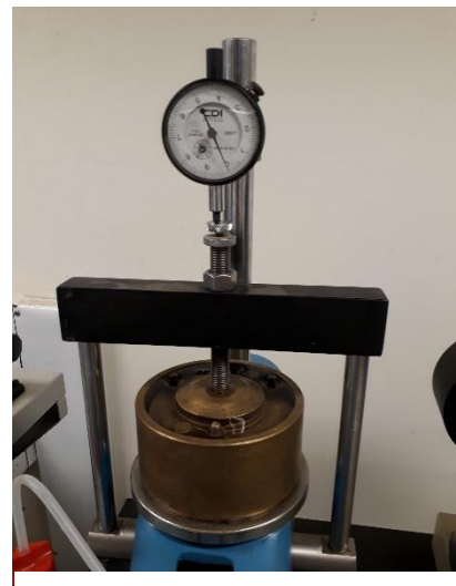
Foto 23. Ensayo de consolidación en ejecución
