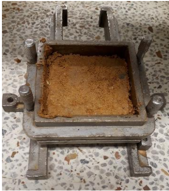
Foto 12. muestra en cámara de corte
