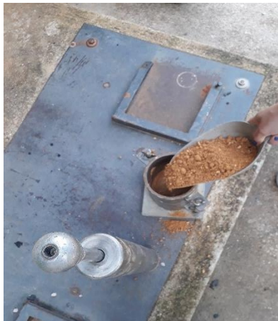
Foto 7. Preparación de las capas a compactar
