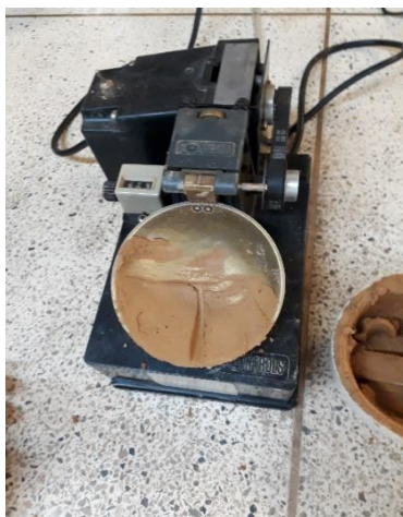
Foto 6. Limite liquido en máquina de Casagrande
