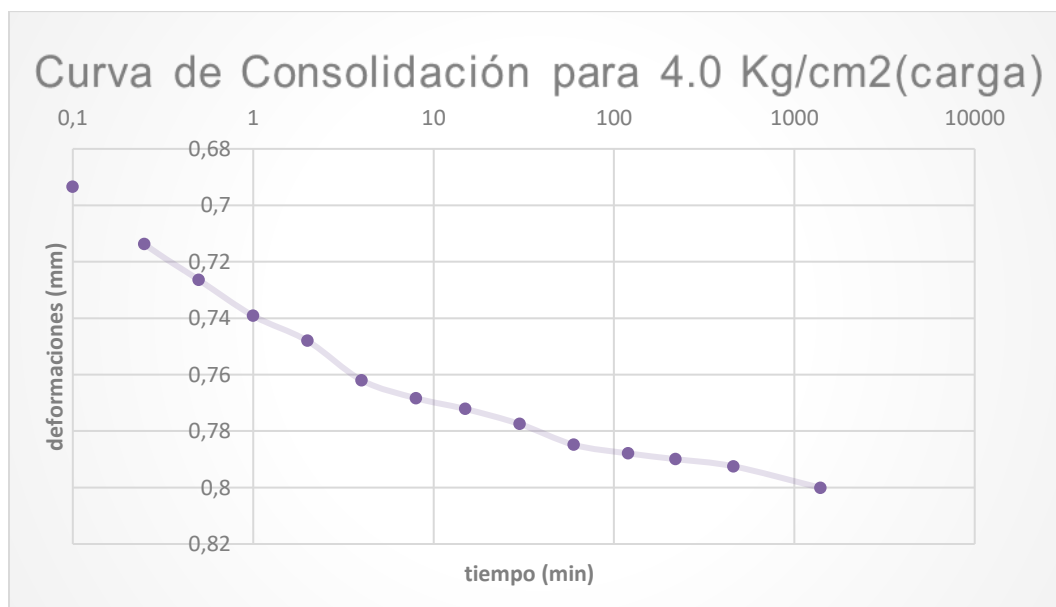
Figura 23. Curva consolidación para carga 4.0 kg/cm 2
