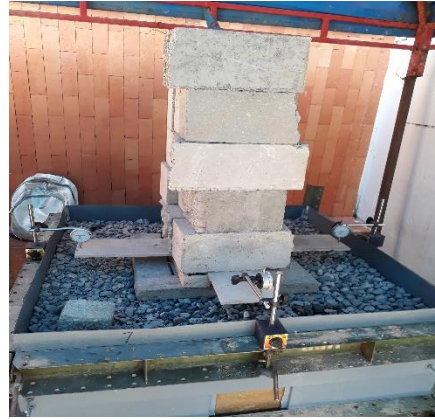
Foto 28. Modelo a escala con carga y deformímetros instalados
