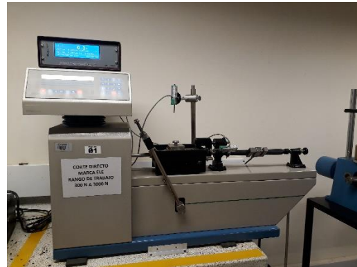
Foto 16 ensayo corte directo en ejecución
