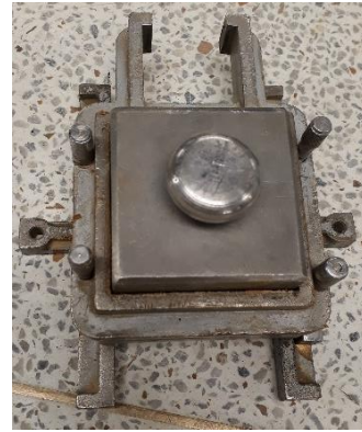
Foto 14. Cámara de corte con carga muerta
