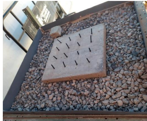
Foto 25. Instalación de drenes en modelo
