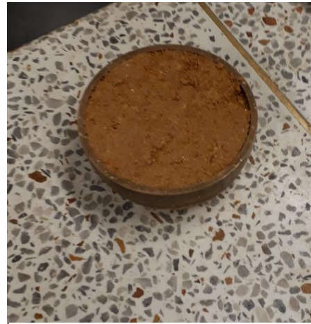
Foto 21 muestra en anillo de consolidación
