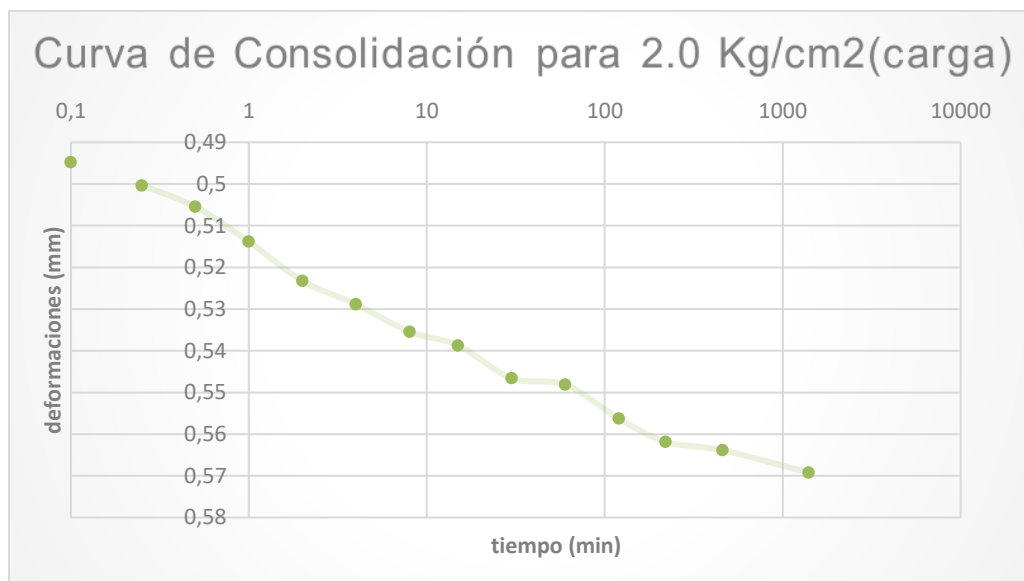
Figura 22. Curva consolidación para carga 2.0 kg/cm 2 . Fuente: los autores
