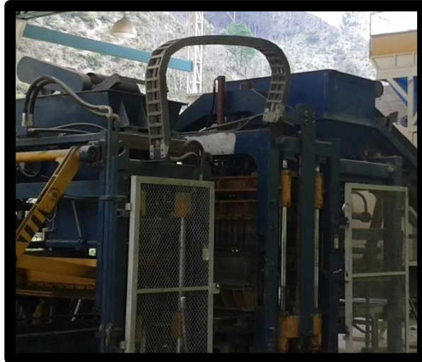
Figura 19: Compresión y vibrado.
