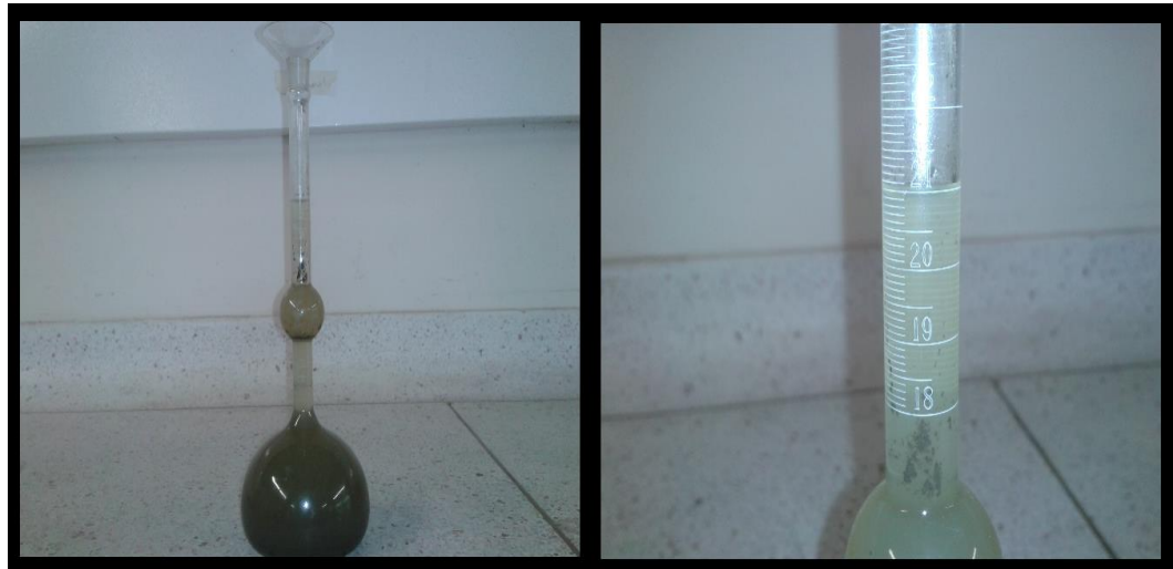
Figura 10: Ensayo peso específico del cemento.
