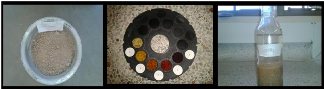
Figura 27: Grado de materia orgánica en la arena mediante la tabla de colores Gardner, agregado fino.
