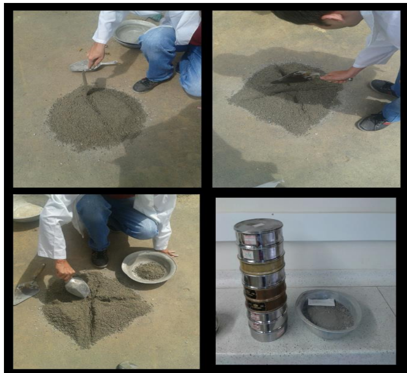
Figura No.6 Ensayo de Granulometría
