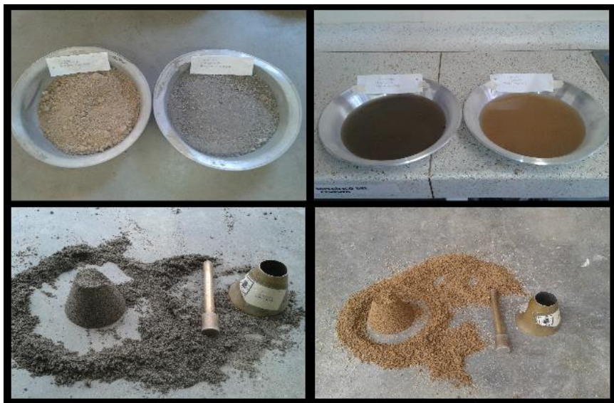
Figura 8: Ensayo peso específico para absorción
