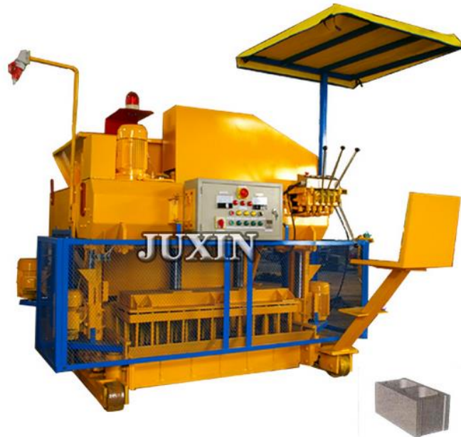
Figura 4: Máquina para fabricación de bloques de mampostería
