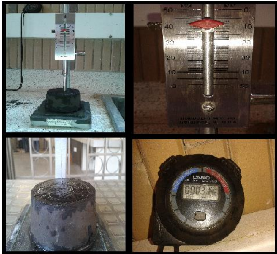
Figura 12: Ensayo consistencia normal de la ceniza.
