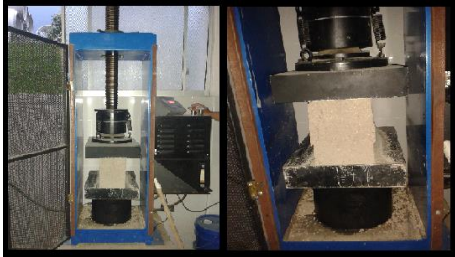
Figura 24: Ensayo de resistencia a la compresión.
