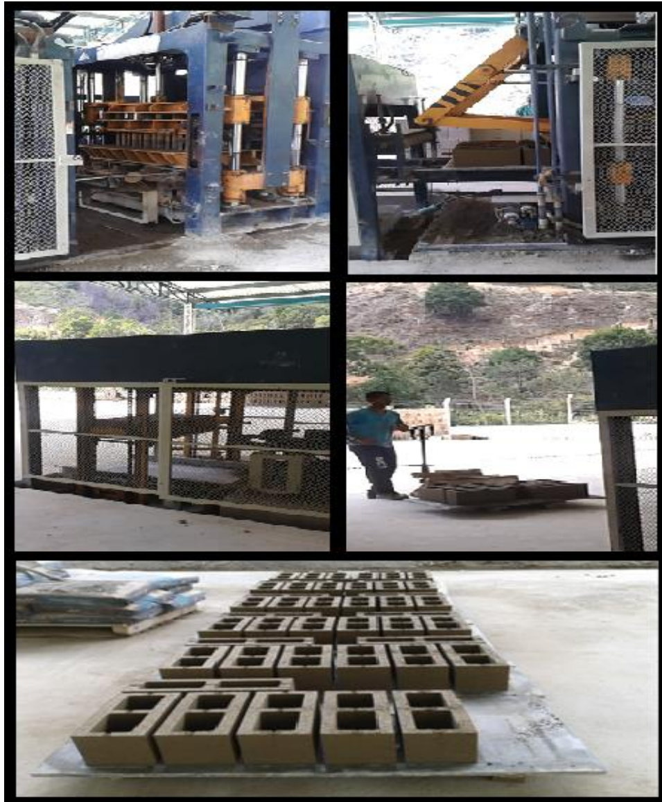
Figura 13: Elaboración de los bloques de concreto.
