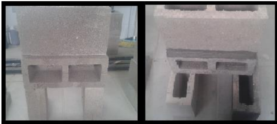
Figura 25: Montaje para el ensayo de permeabilidad
