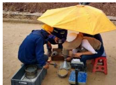
Ilustración 149. Laboratorista y ayudante realizan ensayo de cono y arena
