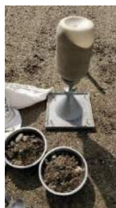
Ilustración 107. Ensayo de cono y arena
