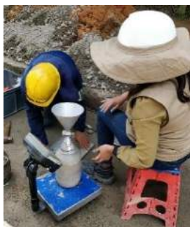
Ilustración 183. Laboratorista y ayudante realizando ensayo de cono y arena abscisa 50
