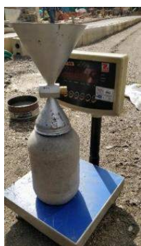
Ilustración 56. Ensayo de cono
