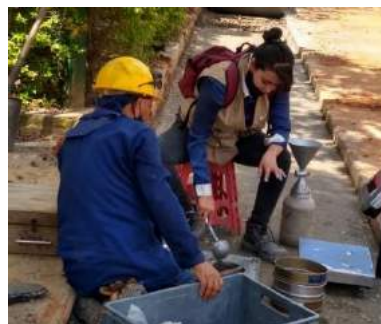
Ilustración 184. Laboratorista y ayudante realizando ensayo de cono y arena abscisa 280
