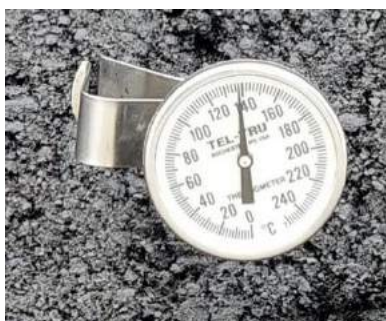
Ilustración 97. Temperatura de aplicación del pavimento
