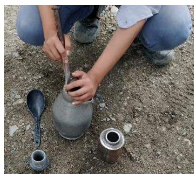
Ilustración 57. Medición de humedad
