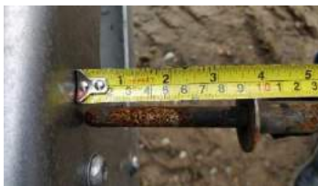
Ilustración 39. Tornillo con medida aproximada a 9.375 centímetros
