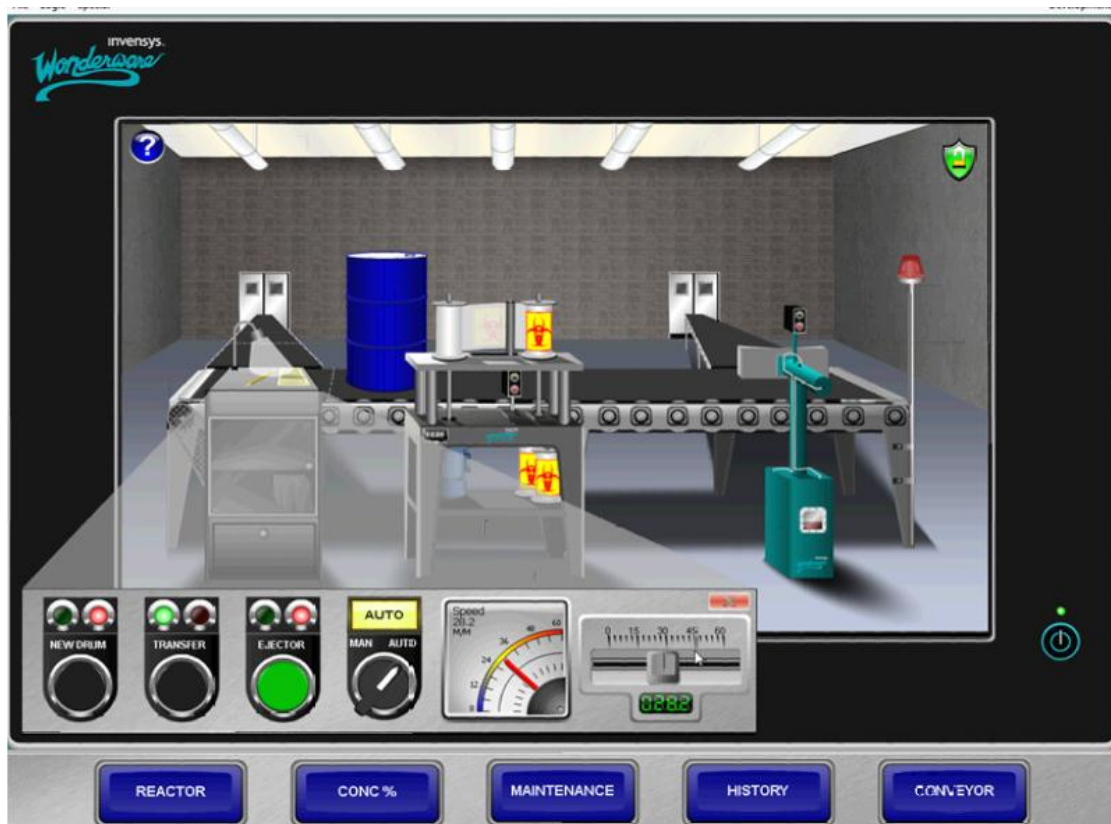
Figura 10. Aplicación HMI / SCADA de un proceso automatizado. Fuente: http:// global.wonderware.com/EN/Pages/WonderwareHMISCADA.aspx
