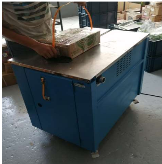
Figura 22. Operario bodega 1 realizando trabajos en zunchadora semiautomática.
