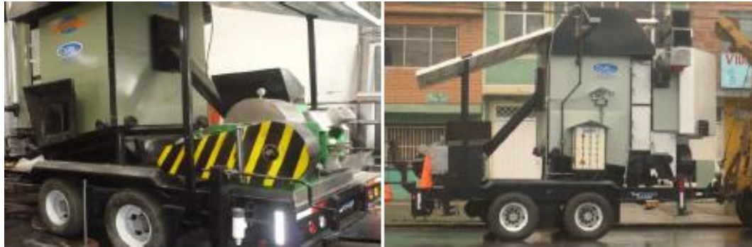
Figura 38. Sistema a vapor móvil de 150kl/h de Cidecolombia.
