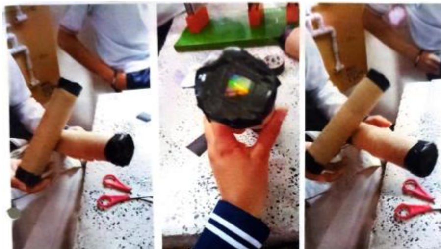
Figura 5: Espectroscopio casero: Tubo papel de cocina, CD y cinta aislante negra.
