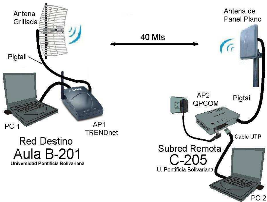
Figura 82. Montaje para el Enlace Inalámbrico WiFi Fuente: El autor del proyecto
