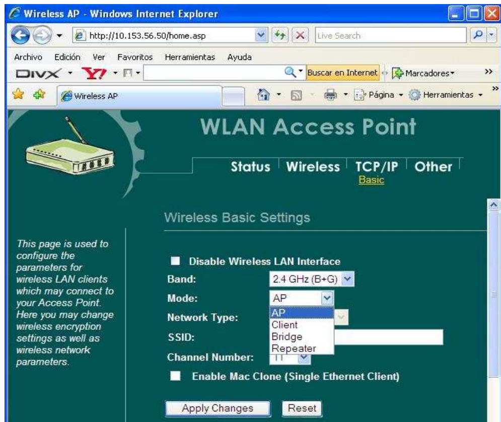
Figura 85. Menú de configuración para la selección del modo Bridge en el AP2 Fuente. El autor del proyecto
