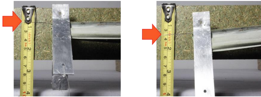
Figura 10. Para cada muestra se toma la medida inicial y las medidas con respecto a la aplicación de cada carga.
