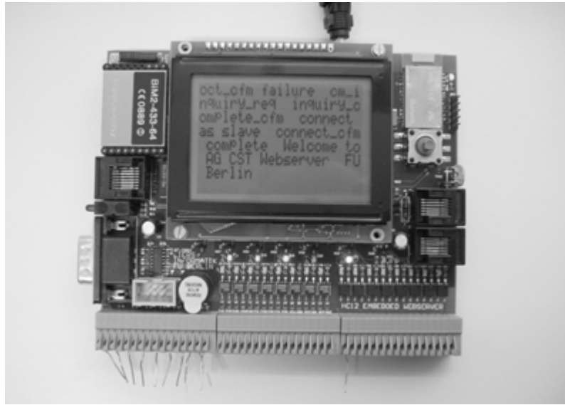
Figure 21 Servidor Web encajado ScatterWeb. 89
