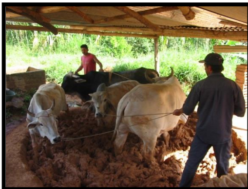
ILUSTRACIÓN 59: BUEYES MEZCLANDO EN CHIRCAL
