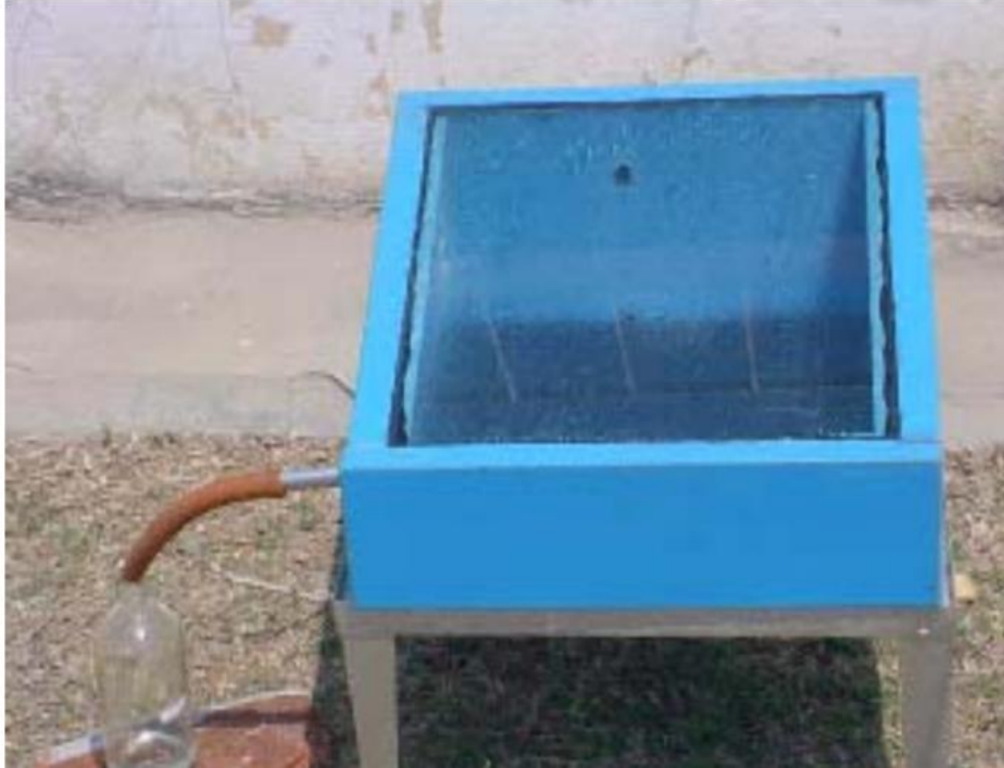
Ilustración 2: Imagen del alambique solar realizado en fibra de vidrio
