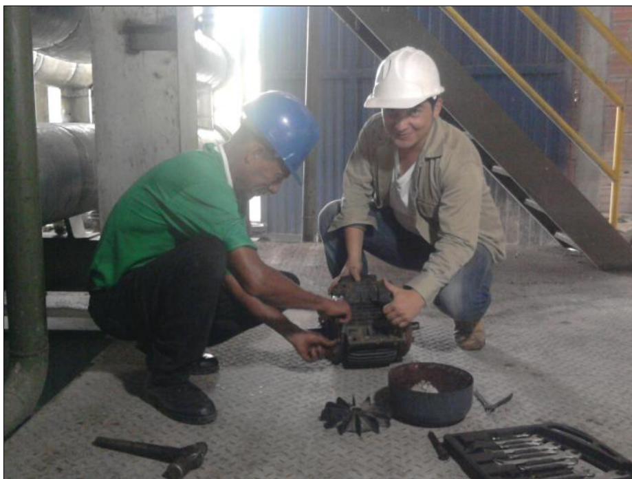
Foto 17. Vista Mantenimiento Motor Agitador (P.E)
