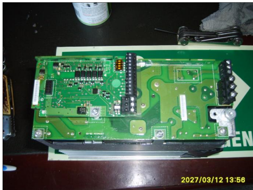
Foto 21. Vista Interna Variador Después del Mantenimiento (P.E)
