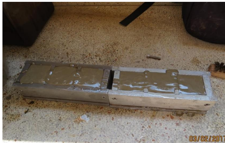
Figura 26. Elaboración de los cubos de lechada
