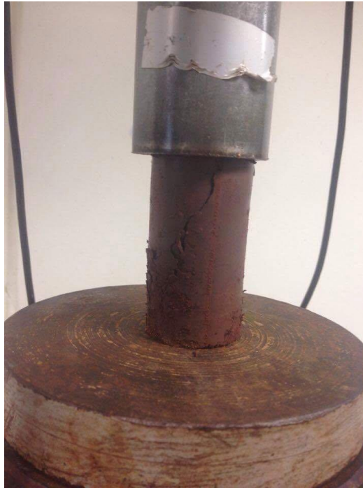
Figura 33. Ensayo de compresión inconfiada muestra 8
