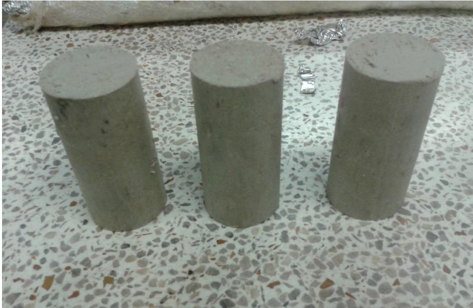
Figura 31. Preparación de especímenes para ensayo de compresión inconfiada muestra 6
