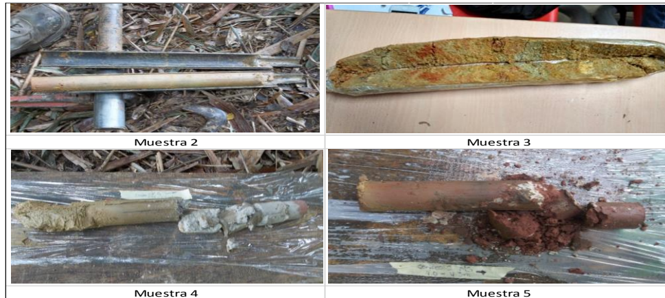
Figura 19. Registro fotográfico de las muestras obtenidas en el ensayo SPT pre-inyección
