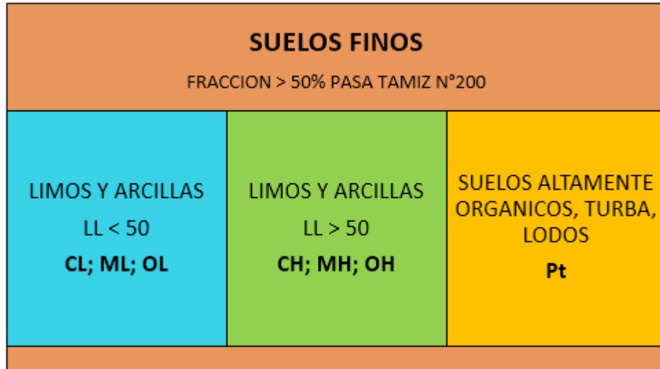
Figura 6. Sistema unificado de suelos (suelos de grano fino)
