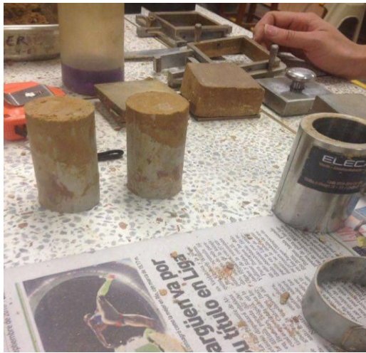
Figura 22. Elaboracion de especimenes para compresion inconfinata
