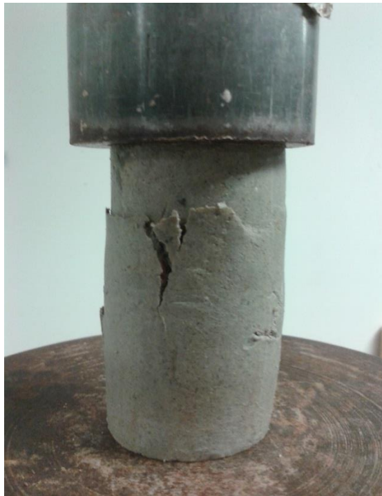
Figura 32. Ensayo de compresión inconfiada muestra 6
