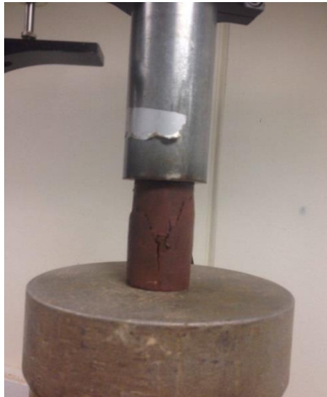
Figura 24. Ensayo de compresión inconfiada muestra 5
