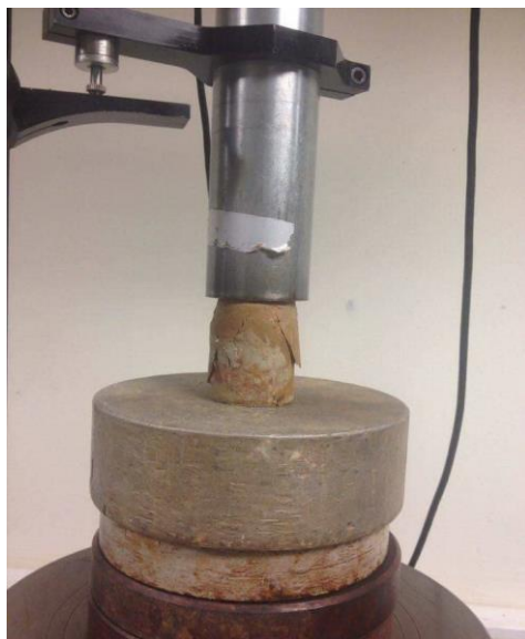
Figura 23. Ensayo de compresión inconfinata muestra 4
