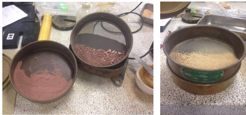
Figura 21 Tamizado de las muestras
