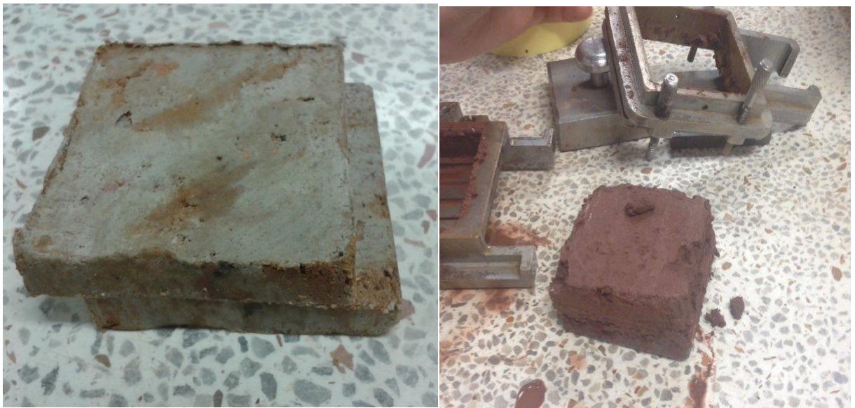
Figura 25. Muestras 4 y 5 respectivamente sometidas a ensayo de corte directo
