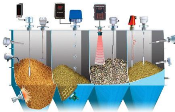
Imagen 18. Diferentes tecnologías para medir nivel en sólidos. [24]
