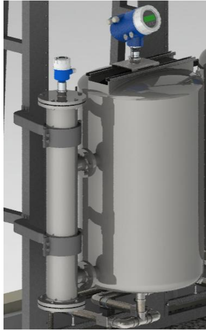
Imagen 33. Conexión tanque TK-100B con el tanque TK-100A y la estructura.
