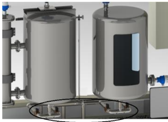
Imagen 31. Instalación válvulas solenoides.
