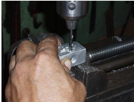
Figura 71. Maquinado del pasador.
