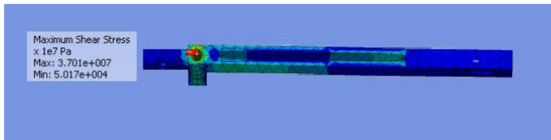
Figura 56. Distribución de esfuerzos en el soporte de los motores según teoría del esfuerzo cortante máximo.
