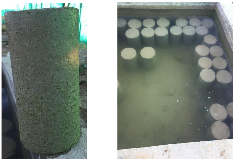
Figura 60. Almacenamiento de cilindros en obra
