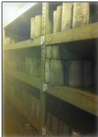
Ilustración 3 Almacenamiento Cilindros En Laboratorios Contecon Urbar
