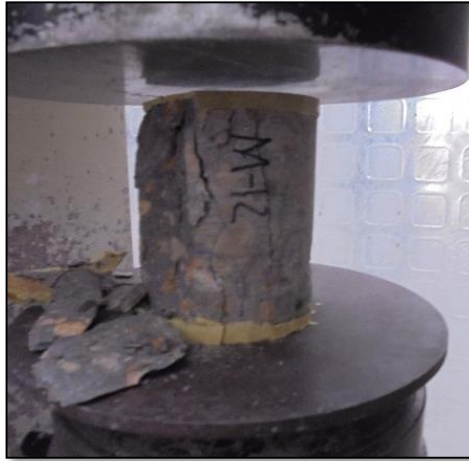
Ilustración 17 Falla Núcleo Después Del Ensayo A Compresión
