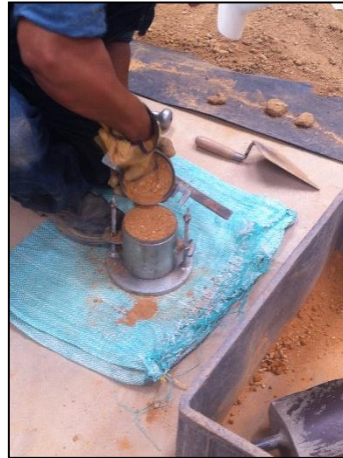
Ilustración 38 Remoción Del Collar Y La Placa Base
