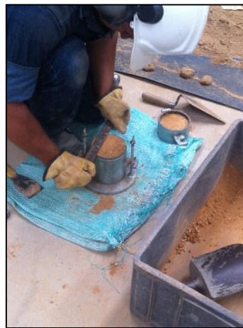
Ilustración 39 Remoción Del Collar Y La Placa Base
