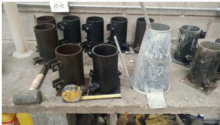
Figura 19. Elementos usados para asentamiento y toma de muestras de concreto
