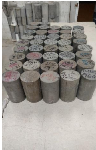
Figura 9. Cilindros de 4"x8" previos a ensayo
