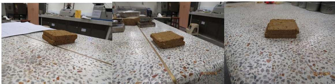
Figura 41 Muestras sometidas a corte directo antes de la inyección
