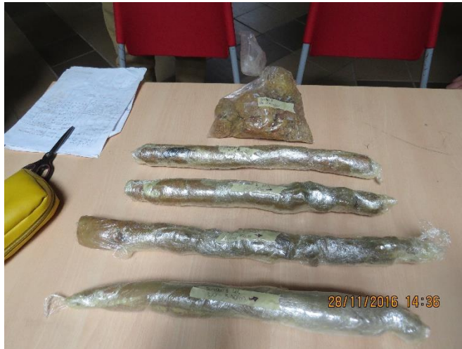
Figura 24 Muestras obtenidas en el Ensayo SPT antes de la inyección
