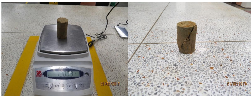
Figura 46 Ensayo de compresión de la probeta 2 – muestra no 3 después de la inyección
