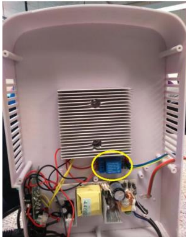
Figura 18: Adaptación del relé a la celda Peltier
